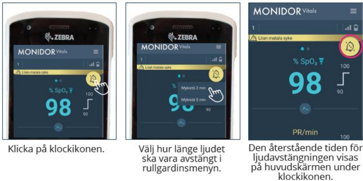
Bild 15: Stänga av larmsignalen från den trådlösa patientmonitorn
