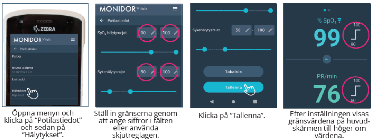
Bild 16: Ställa in larmgränser på den trådlösa patientmonitorn.
